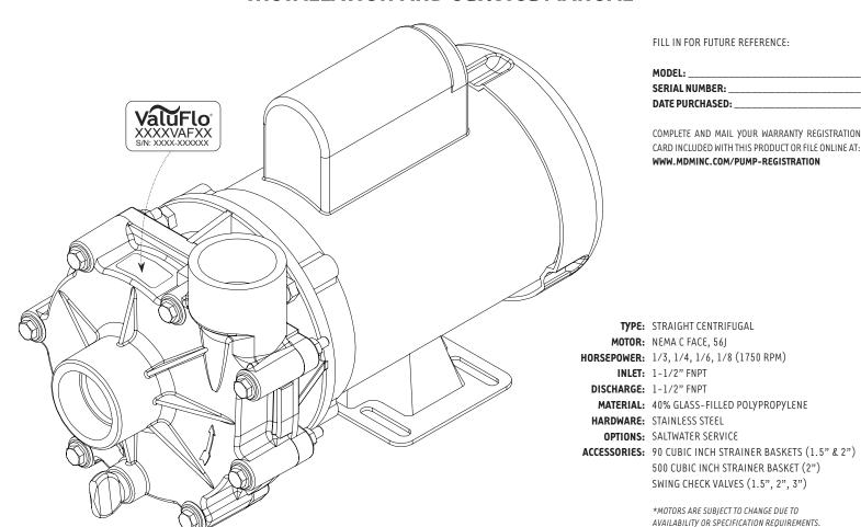
Model 3300VAF21 4500VAF21 5100VAF22 6100VAF23 INLET 1.5" 1.5" 1.5" 1.5" DISCHARGE 1.5" 1.5" 1.5" 1.5" MAX FLOW (gph) 3300 4500 5100 6100 21' 21' 22' MAX HEAD (feet) 23' MAX POWER (watts) 215 253 293 344 MAX CURRENT (amps) 1.9 @ 115V 2.2 @ 115V 2.6 @ 115V 3.0 @ 115V VOLTS 115/230 115/230 115/230 115/230 MOTOR HP 1/3, 1/4, 1/6, 1/8 1/3, 1/4, 1/6, 1/8 1/3, 1/4, 1/6, 1/8 1/3, 1/4, 1/6, 1/8 MOTOR TYPE 56J 56J 56] 56J MOTOR ENCLOSURE TEFC TEFC TEFC TEFC
