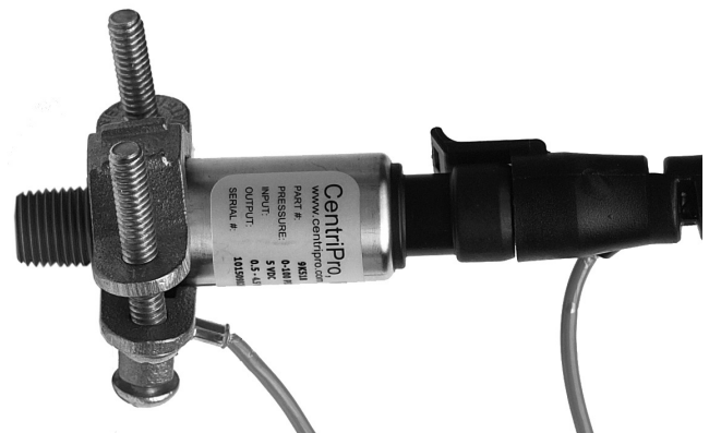
Figure 1 — Mise à la terre du capteur
