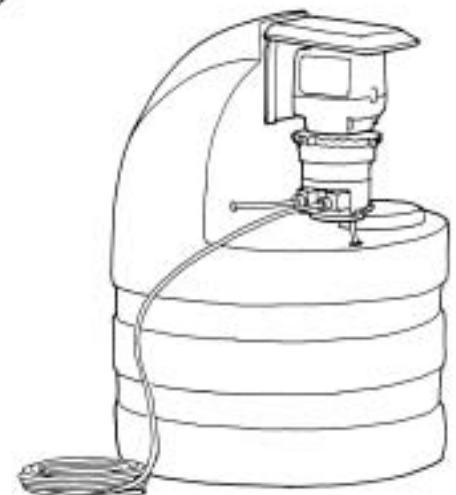
TANQUE CON DOSIFICADOR INSTALADO
