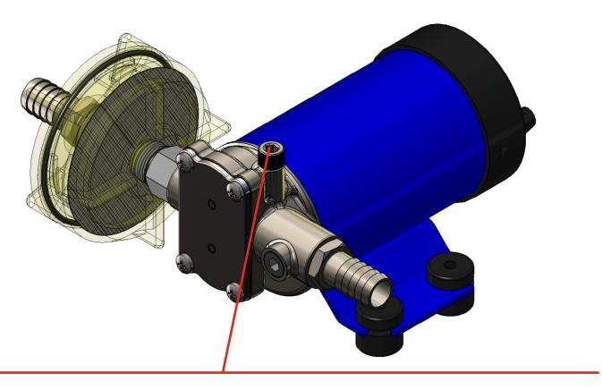
All'avviamento pompa agire brevemente sulla valvolina manuale per sfogare l'aria e favorire l'adescamento pompa. Una volta azionata la pompa, richiudere la valvolina.
