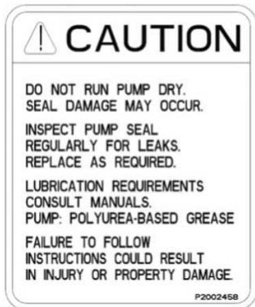
Figura 1: Bombas lubricadas con grasa
