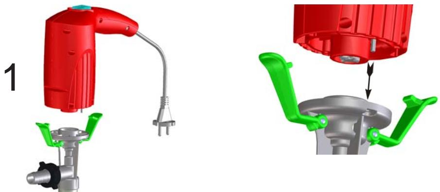
Positionner le moteur de façon que la goupille s'encoche dans un des deux trous.
