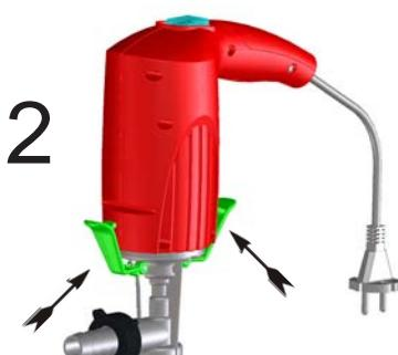
Die Spannhebel in Richtung Motor drücken, bis beide hörbar
