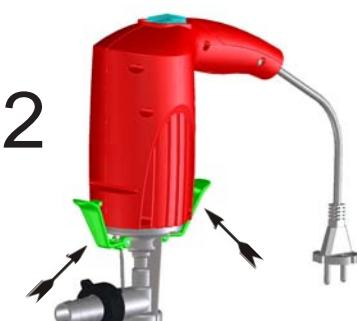
Pousser les 2 leviers de serrage vers le moteur jusqu'à ce que ceux-ci s'encliquètent de façon audible.
