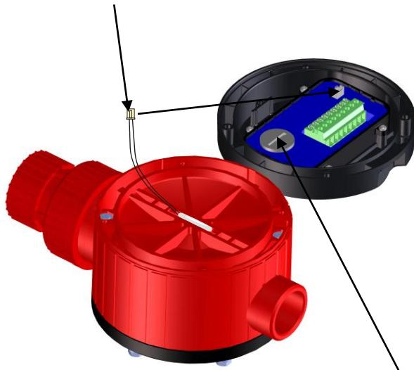
Das Batteriefach mit einem geeigneten Werkzeug öffnen.
