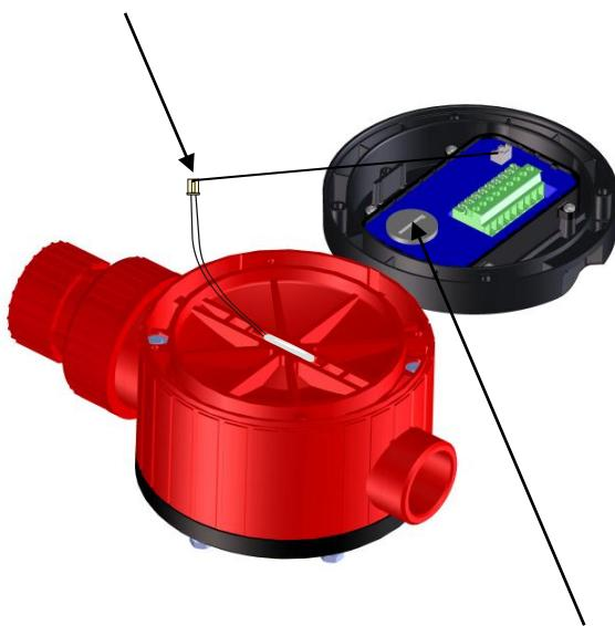
Ouvrir le compartiment de la pile à l'aide d'un outil approprié.
