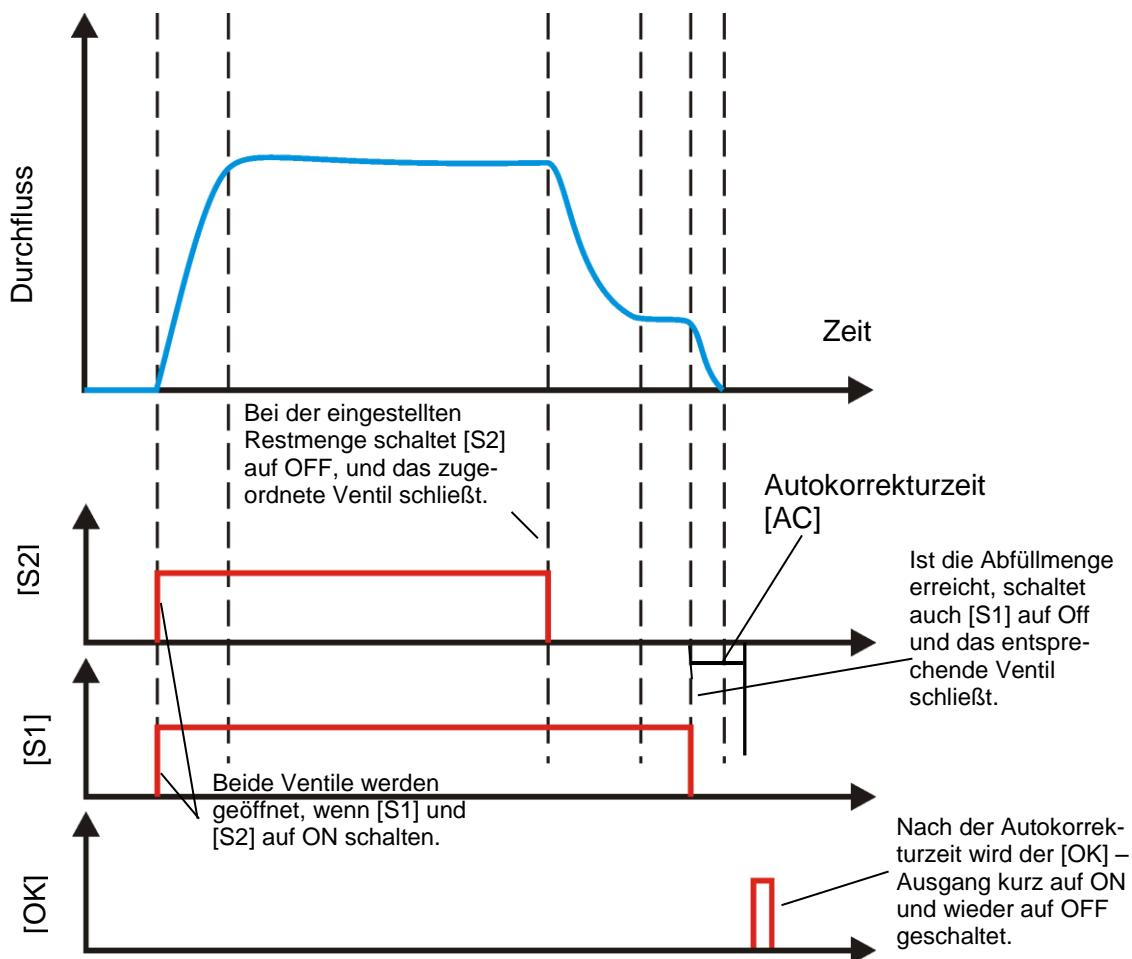
Falls das Messgerät während der Abfüllung ausfällt und keine Impulse mehr erzeugt, würde das Ventil nicht mehr geschlossen werden.
