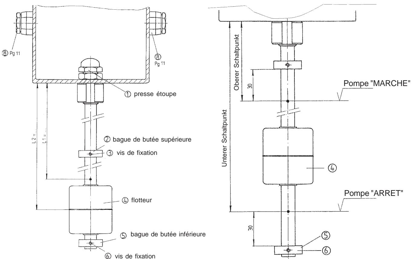
Pousser manuellement le flotteur ( rep. 4 ) jusqu'en butée de la bague supérieure.
