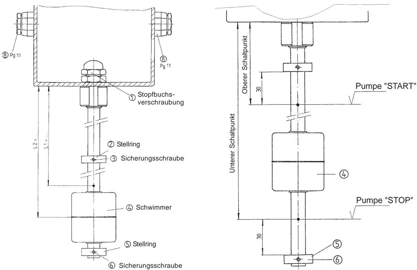
Den Schwimmer ( Pos. 4 ) von Hand bis zum Anschlag des oberen Stellringes schieben.
