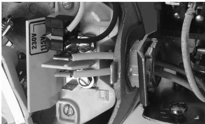
Figura 15 - Tensión configurada para 115 V, tipo ficha.
