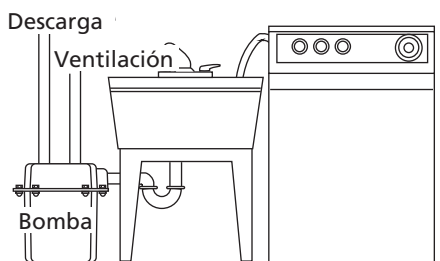
Figura 10 - Instalación típica en lavaderos y lavarropas
