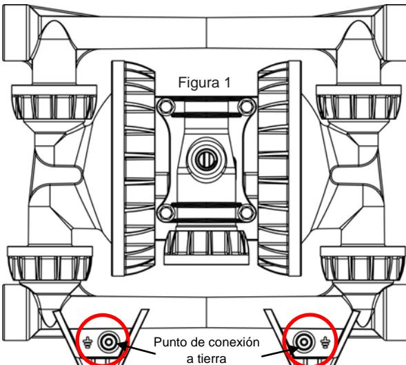
La bomba AOD SP100 se puede conectar a tierra a través de las patas de montaje, ubicadas en el múltiple de entrada (Figura 1). A fin de reducir el riesgo de chispas de electricidad estática, conecte a tierra la bomba y todos los otros equipos ubicados en el área de bombeo. Los cables de conexión a tierra deben ser del tamaño adecuado y se deben instalar según los códigos eléctricos locales y nacionales.
