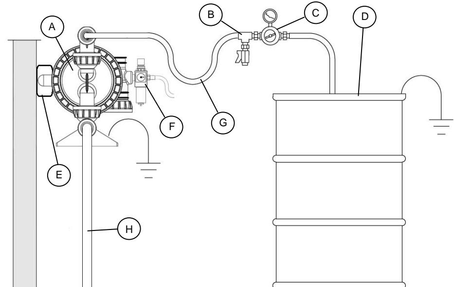
Typischer Einbau für unterirdischen Tank
