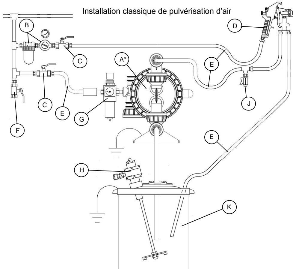
\*REMARQUE : Fixez solidement la pompe sur une surface solide à l'aide de supports et d'attaches appropriés pour l'application.
