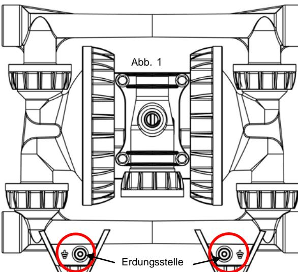
Die SP100 AOD-Pumpe kann durch die Montagefüße am Einlassverteiler (Abb. 1) geerdet werden. Zur Verringerung des Risikos statischer Funken müssen die Pumpe und alle anderen Ausrüstungen im Bereich des Pumpensystems geerdet sein. Massedrähte müssen ausreichenden Durchmesser haben und gemäß lokalen und nationalen Elektrikvorschriften installiert werden.
