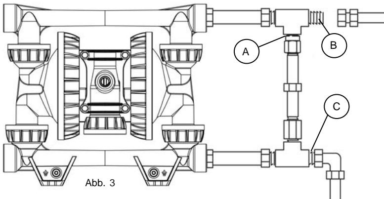
Bei einigen Systemen muss eventuell im Pumpenauslass ein Druckentlastungsventil eingebaut werden, um zu hohen Druck und ein mögliches Bersten der Pumpe oder des Schlauchs zu vermeiden (Abb. 3).
