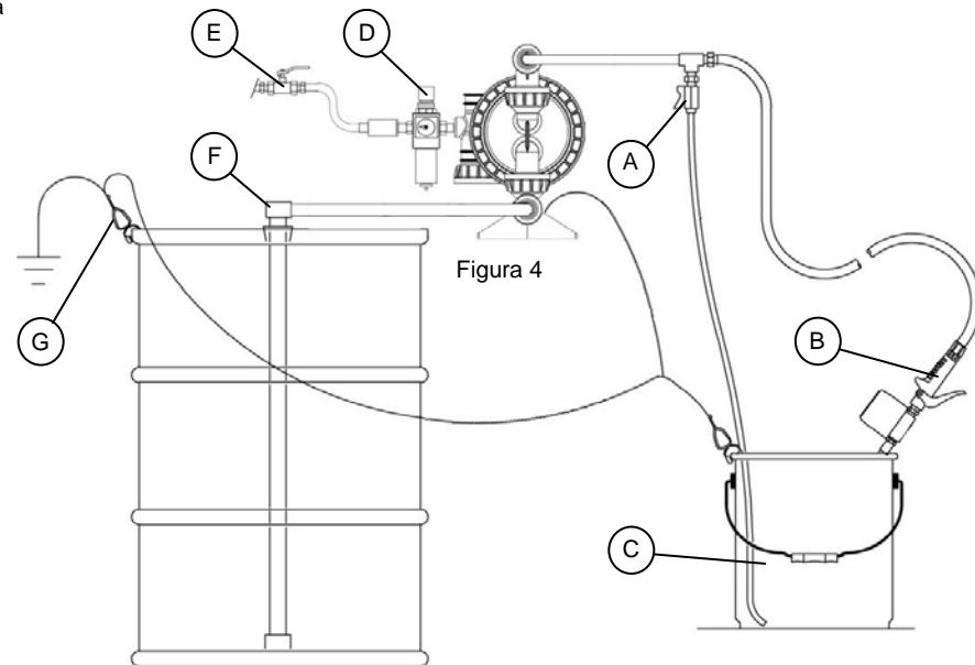
**ADVERTENCIA** ¡ADVERTENCIA! APAGADO ADECUADO DE LA BOMBA. La vida útil del diafragma y del sello se puede ver reducida si se aplica presión de aire al motor de la bomba durante períodos prolongados cuando no se está usando la bomba. Para evitar que esto suceda, se debe instalar una válvula solenoide de 3 vías que alivie automáticamente la presión del motor de aire cuando se complete un ciclo de medición.
