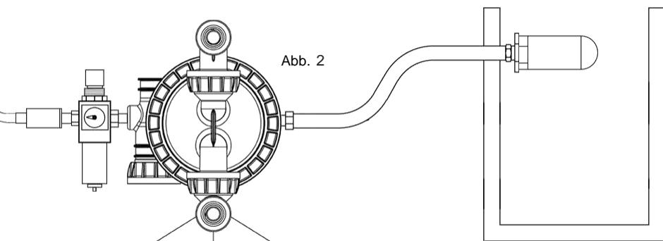
Einen elektrisch leitfähigen Abluftschlauch anbringen und den Schalldämpfer am Ende aufsetzen. Der Mindestinnendurchmesser des Schlauchs beträgt 9,5 mm (3/8 Zoll). Falls der Schlauch länger als 4,5 m ist, muss ein größerer Schlauchdurchmesser vorgesehen werden. Beim Verlegen des Schlauchs darauf achten, dass keine Knicke und scharfe Biegungen vorhanden sind, die die Luftströmung blockieren könnten.
