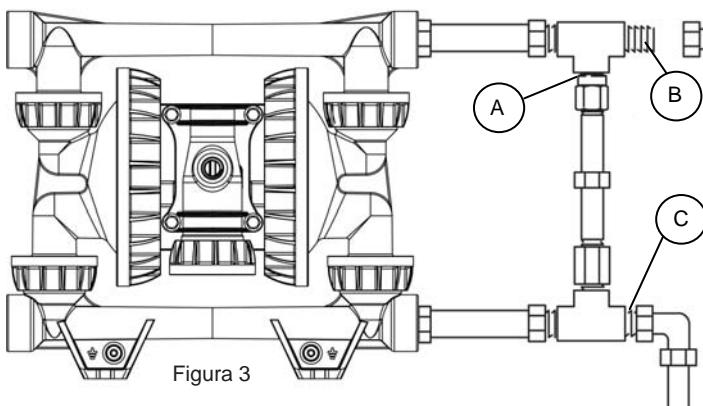
Es posible que algunos sistemas requieran la instalación de una válvula de alivio de presión en la salida de la bomba para evitar el exceso de presión y la posible ruptura de la bomba o la manguera (Figura 3).
